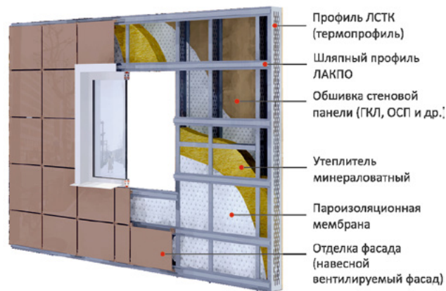
Рис. 1 Состав стеновой панели.
