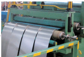
2. Раскрой металла (резка металла на полосы)
